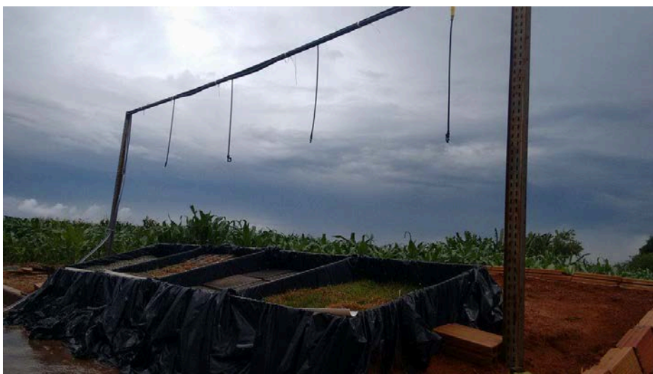
Figura 6: Microaspersores fixados ao pórtico sobre os pavimentos.
